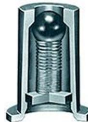
Equípate las puntas de la boquilla con válvulas de retención para ayudar a prevenir goteos cuando la bomba esté apagada. Asegúrate de que las válvulas de bola con resorte estén funcionando correctamente.
